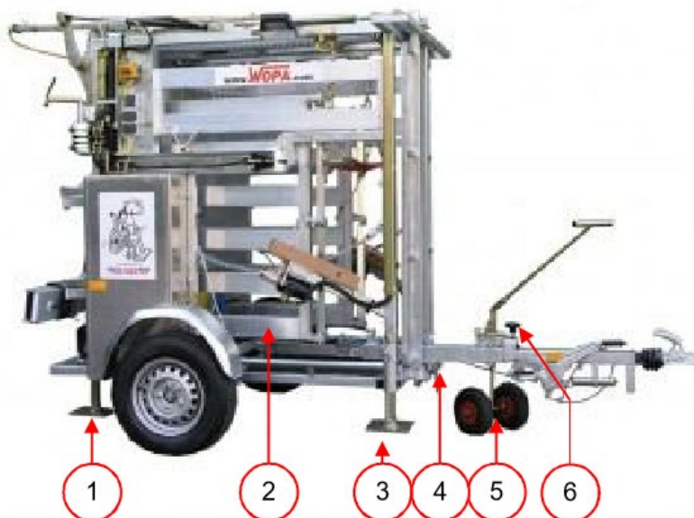
图4：修蹄机从运输状态转换为工作状态的具体操作内容
